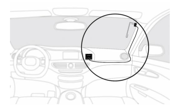
Dazu die schwarze Elektronikbox in unmittelbare Nähe zum Rahmen der Windschutzscheibe platzieren. Das kürzere Ende (Kupferfolie mit schwarzer Schutzfolie) auf den Metallrahmen des Fahrzeugs befestigen. Kleben Sie die durchsichtige längere Folie senkrecht zum Windschutzrahmen auf.
