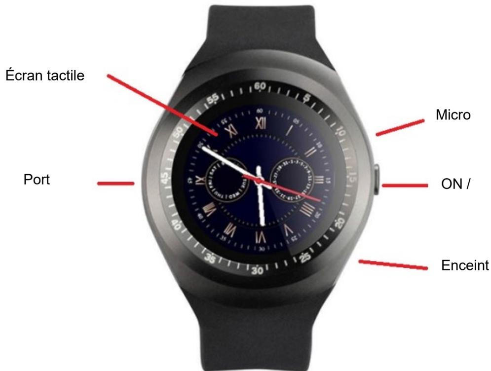
**ACTIVÉ/DÉSACTIVÉ** : maintenez le bouton appuyé pour allumer/éteindre l'appareil et appuyez pour quitter le menu et aller à l'horloge. Appuyez en mode horloge pour allumer/éteindre l'affichage.
