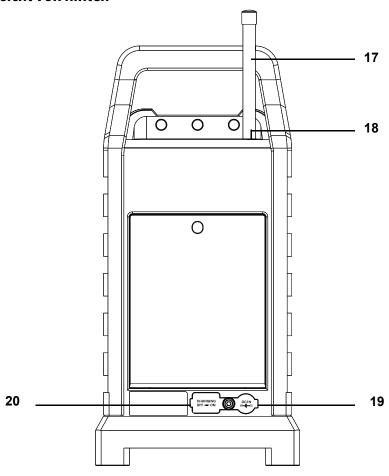
17 ausziehbare FM-Teleskopantenne (bei Lieferung nicht montiert)
