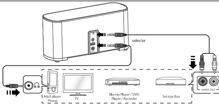
1. Verbinden Sie mit einem Audiokabel den Audio-Ausgang des externen Gerätes, z. B. eines MP3-Players, mit der Buchse **AUX**.
