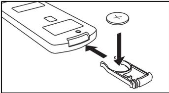
3. Legen Sie die Batterie (CR2025 3V) ein bzw. tauschen Sie die alte Batterie gegen eine neue. Der Pluspol (+) der Batterie muss nach oben zeigen.
