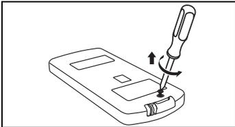
1. Lösen Sie die kleine Schraube auf der Unterseite der Fernbedienung mit einem Kreuzschlitzschraubendreher.
