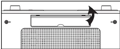
1. Klappen Sie den Stützfuß auf der Geräte-Unterseite vollständig heraus.
