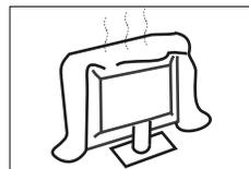
No bloquee los orificios de ventilación en la cubierta posterior. La ventilación adecuada es esencial para evitar fallas de los componentes eléctricos.
