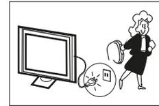
Cuando el receptor de televisión no se utiliza durante un período prolongado de tiempo, es aconsejable desconectar el cable de alimentación de AC de la toma de corriente alterna.
