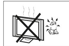
Evite exponer el receptor de televisión directamente al sol y otras fuentes de calor. No coloque el receptor de televisión directamente sobre otros artefactos que emitan calor, por ejemplo, los reproductores de cintas de video y amplificadores de audio. No coloque fuentes de calor y fuego como velas encendidas, sobre el televisor o cerca de él.
