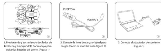
1. Presionando y sosteniendo los lados de la batería y empujándola hacia abajo para quitar las baterías del dron. (Figura 1)
