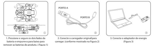
Conforme mostrado na figura acima, após a desconexão, conecte a interface A ao USB do computador, a luz vermelha pisca rapidamente, ao conectar a interface B a bateria de lítio, a luz vermelha ficará acesa por um longo tempo. E a luz vermelha apagará quando estiver totalmente carregada, com um tempo de carregamento de cerca de 180 minutos.
