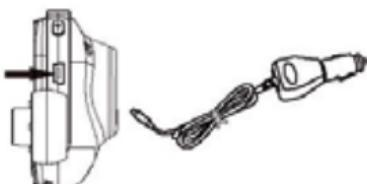
**Figyelem:** A töltésjelző lámpa folyamatosan, piros színnel világít, ha a felvétő 12 V-os töltőhöz csatlakoztatja. Ha az akkumulátor teljesen fel van töltve, a töltésjelző lámpa kialszik.
