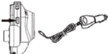
**Achtung:** Die Ladeleuchte leuchtet konstant rot, wenn der Videorekorder an ein 12-V-Ladegerät angeschlossen ist. Wenn der Akku vollständig geladen ist, erlischt die Ladeleuchte.
