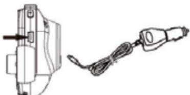
**Attenzione:** La spia di ricarica si accende di colore rosso fisso quando il registratore è collegato ad un caricabatterie da 12 V. Quando la batteria è completamente carica, la spia di ricarica si spegne.
