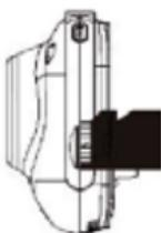
Använd inte styrka för att sätta in ett microSD-kort i kortfacket. Efter kontroll att microSD-kortet har satts in med rätt sida, tryck in kortet tills det låses i kortfacket.
