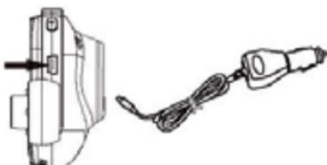
**Opmerking:** Het oplaadlampje brandt continu rood wanneer de DVR is aangesloten op een 12 V oplader. Als de accu volledig is opgeladen, dooft het oplaadlampje uit.
