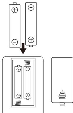
1. Öffnen Sie den Batteriefachdeckel auf der Unterseite der Fernbedienung.
