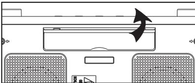
1. Klappen Sie den Standfuß auf der Geräte-Unterseite vollständig heraus.
