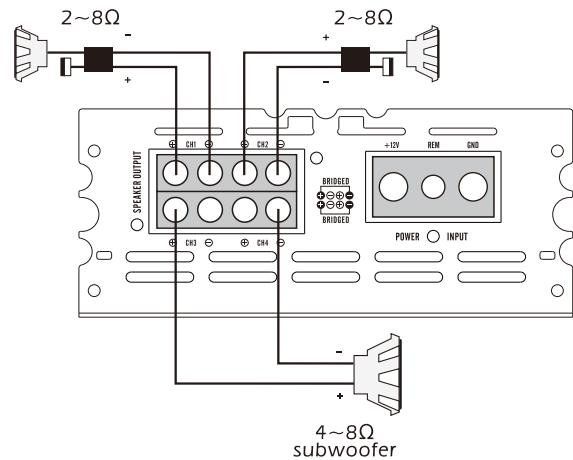
Système 3 : connexion pontée à 2 canaux
