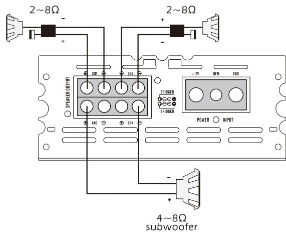
Sistema 3: conexión en puente de 2 canales
