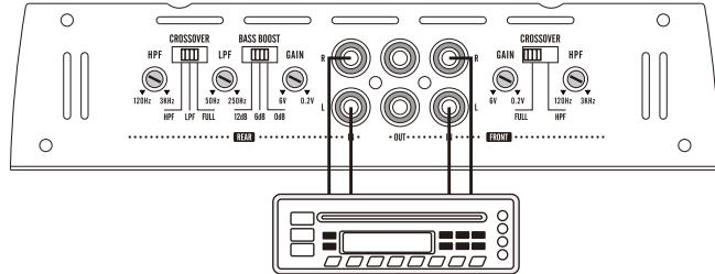
Sistema 3: conexão em ponte de 2 canais
