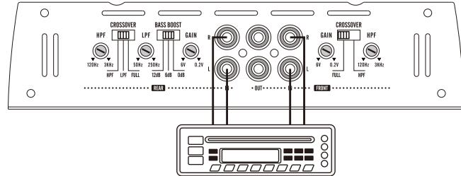
Sistema 3: conexión en puente de 2 canales
