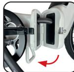
**Rahmenverriegelung:** Den Klapphebel (23) öffnen und vorderen Teil des Fahrrads nach hinten schwenken bis die praktische Magnethalterung beide Teile fixiert. (Das Schwenken gelingt am einfachsten, wenn das Fahrrad auf dem Ständer steht und etwas Druck auf den hinteren Teil des Fahrrads ausgeübt wird.)
