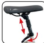
**Sattel:** Öffnen Sie den Schnellspanner an der Sattelstütze (19) und ziehen Sie den Sitz auf die gewünschte Höhe. Schließen Sie den Schnellspannhebel.
