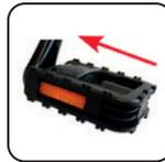
**Pedale falten:** Pedale in Richtung Kurbel drücken und dann um 90 Grad klappen.
