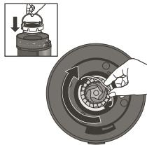
2. 确保锥磨轮顶部没有咖啡研磨残留物。如果有残留，您可以使用提供的刷子清洁；
