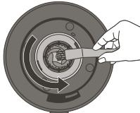
3. 将咖啡豆杯底部解锁图标 与粗细调节圈上的箭头 对齐。
