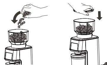
3.磨咖啡豆机有52档位可供调节粗细。要调整研磨粗细，旋转咖啡豆杯，根据您正在冲泡的咖啡类型从细到粗进行调整
