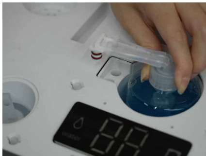
拧紧泡沫剂导盖后放入槽内
