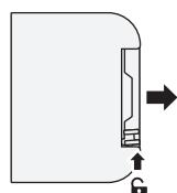
1. Drücken Sie den kleinen Hebel an der Seite des Batteriehalters etwas in Richtung Mitte und ziehen anschließend den Batteriehalter in Pfeilrichtung aus der Fernbedienung.
