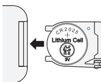
2. Tauschen Sie die alte Batterie gegen eine neue. Der Pluspol (+) der Batterie muss nach oben zeigen.
